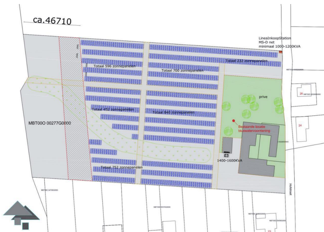
afbeelding 1 zonneweide Hofstraat - opstelling 3572 panelen
